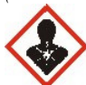
karzinogen keimzellmutagen reproduktionstoxisch Sensibilisierung der Atemwege spezifische Zielorgan-Toxizität Kat. 1, 2 (nach einmaliger oder wiederholter Exposition) Aspirationsgefahr Kat. 1
